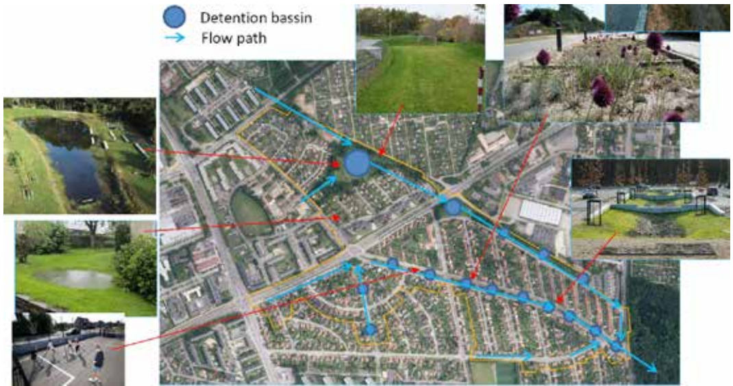
Figur 6. I Aarhus ble et nettverk av LOD-tiltak som tørre og våte dammer, vadier, plener og idrettsplasser som kan stå midlertidig oversvømt, brukt for å håndtere nedbøren slik at bygg ikke ble skadet og overløpsdriften redusert (foto: Aarhus Vand og EnviDan AS).
