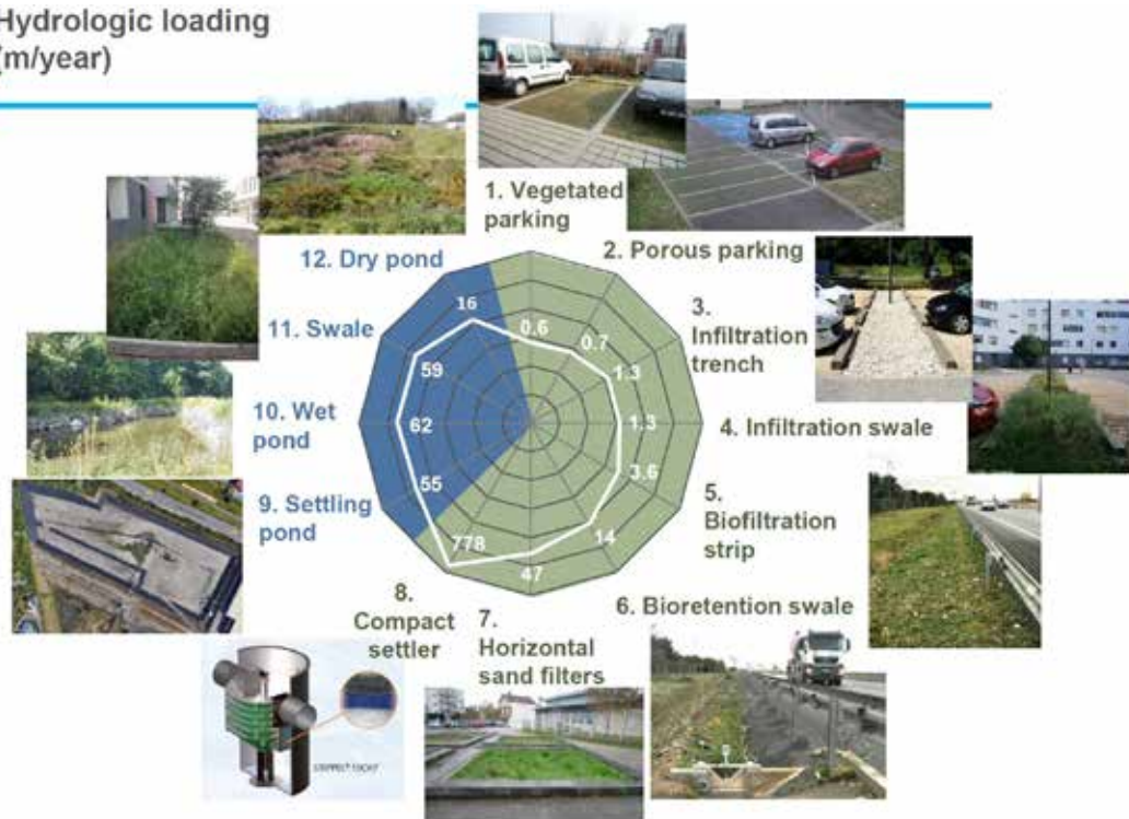
Figur 4. Overvannsløsninger som er undersøkt og presentert av Marie-Christine Gromaire-Mertz. Resultater fra studiene vises i Figur 3. I noen grad gjenspeiles resultatene i forskjellig hydraulisk belastning (vann tilført over tiltaksarbeidet per år; m^3/m^2 per år).
