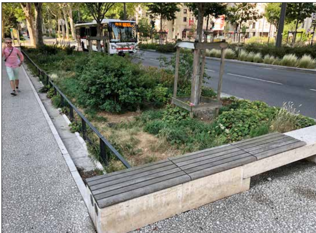
Figur 2. Garibaldi i Lyon. Eksempel på at en motorvei igjennom byen er blitt til en boulevard hvor mye trafikanter og blågrønne løsninger prioriteres. Det har blitt bygd brede fordypede midtdele som tar mye overvann fra gang- og sykkelarealene og har en rik vegetasjon; en type regnbed. I tillegg lagres vannet under grunnen i basseng som pumper vann i tørre perioder for å vanne plantene. Arealer for gående og møbleringsonen har i tillegg permeable dekker.
